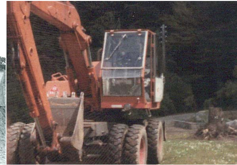
Arbejdet går fra jordoverfladen og nedad, og det job tager maskiner sig af. Her er det en Salta 1302 gravemaskine.
